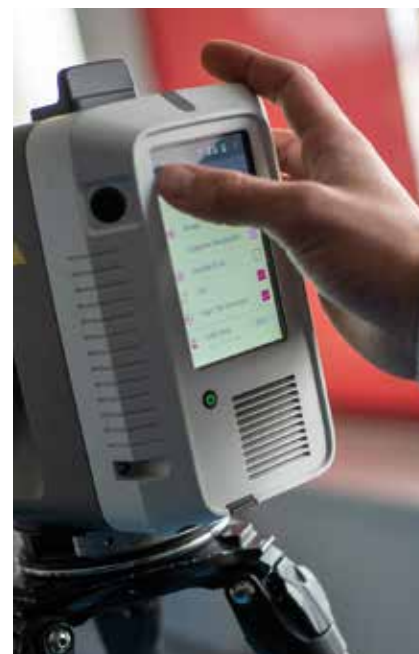
Ctec-Vision travaille avec des scanners laser RTC 360° à la pointe de la technologie. Ces scanners permettent de capturer la réalité en 3D dans un temps record. Le scanner génère des nuages de points qui, une fois intégrés à un logiciel CAO, permettent de réaliser des plans en 2 ou 3 dimensions.
